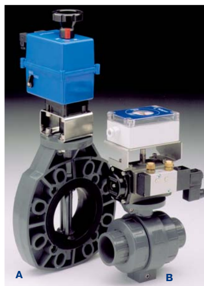
A: Электрический привод без блокировки B: Пневматический привод одинарного действия
